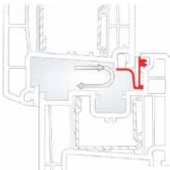
Kod porasta pritiska AirComfort automatski zatvara prema Bernulijevom principu.
